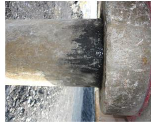
**2. Wenig Ölverlust im Zylinder, keine Reparatur erforderlich**
