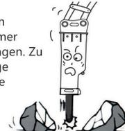
Nicht aufschräge Schlagfläche schlagen, sonst werden die Ersatzteile des Hammers beschädigt.
